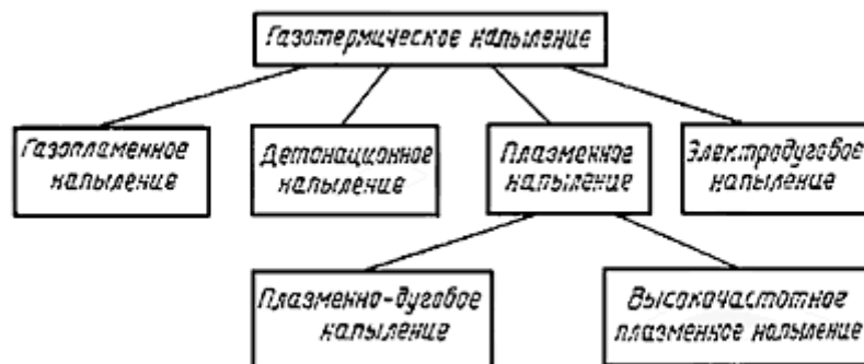
Рис. 3.3. Классификация газотермических покрытий по энергетическому признаку
