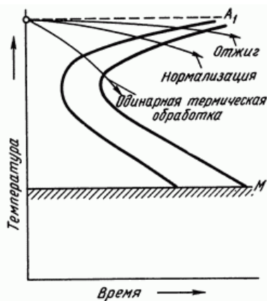
Рис. 1. Кривые охлаждения для отжига, нормализации и одинарной термической обработки, наложенные на диаграмму изотермического распада аустенита
