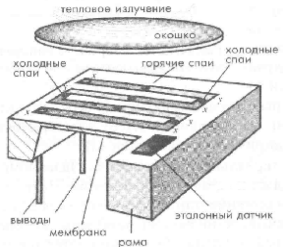
Рис. 9. Схема термоэлемента с эталонным датчиком температуры (x и y являются разными материалами)
