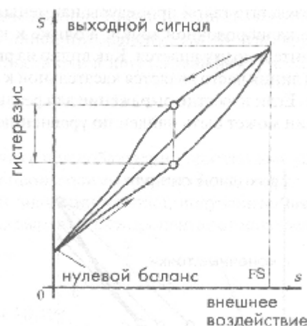
Рис. 3. Передаточная функция с гистерезисом
