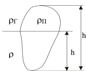
$\Gamma$  – газ,  $\Pi$  – поплавок
