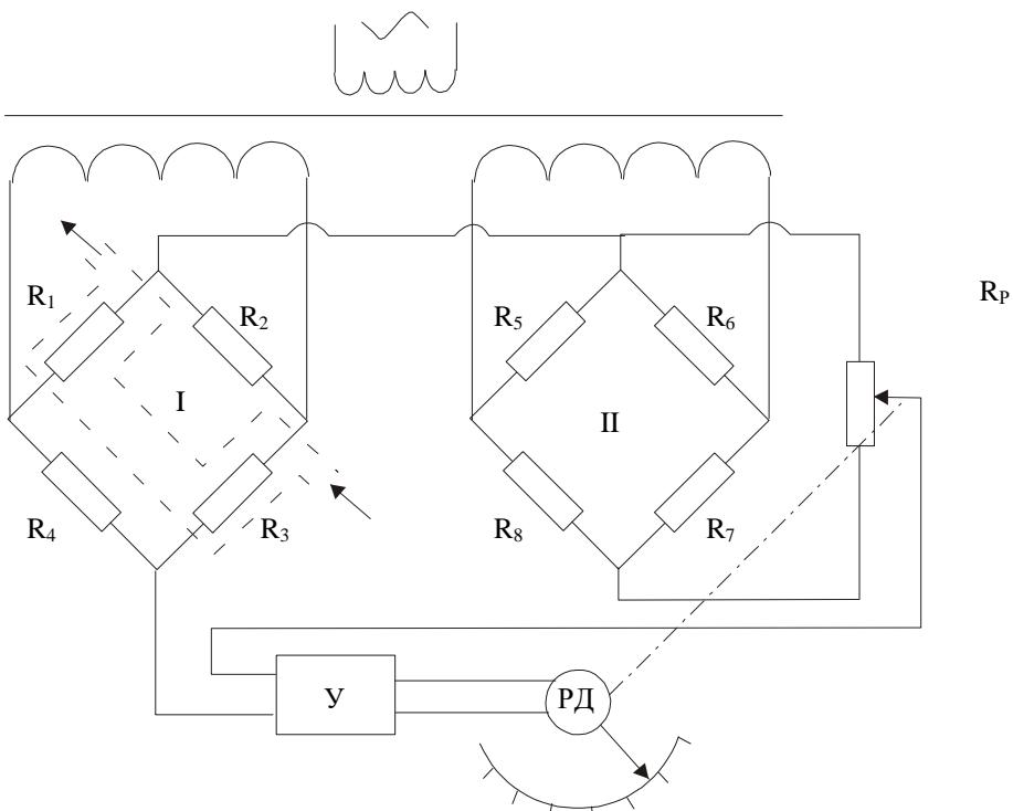
Компаратор содержит 2 неравновесных моста: I – рабочий, II – сравнительный.
