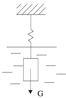
Плотномеры с полностью погруженным поплавком.
