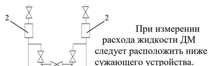
При измерении расхода жидкости ДМ следует расположить ниже сужающего устройства.
