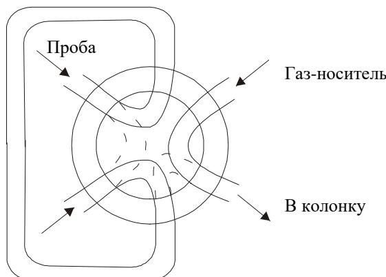
При повороте газ-носитель захватывает пробу и поступает в колонну.
