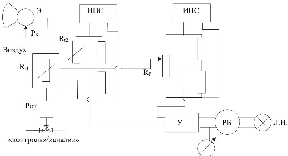
Рассмотрим схему на основе сигнализатора СВК-3М. Он одноканальный.
