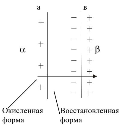
Пусть  $a$  и  $b$  – проекции стеклянной пленки, разделяющие растворы  $\alpha$  и  $\beta$  с различными концентрациями  $H^+$ .
