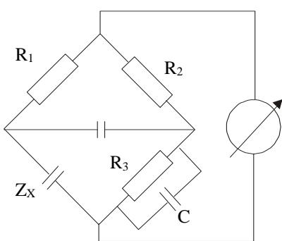
$Z_X$  – полное сопротивление измерительной ячейки
