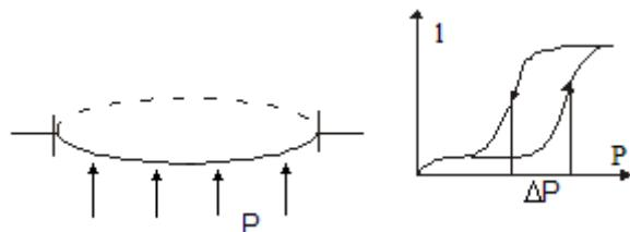
Перескакивает из одного положения в другое. Используется в сигнализации. Имеет два устойчивых положения. С целью увеличения чувствительности наносят кольцевые гофры, из них выполняют мембранные коробки.
