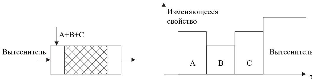
Проявительный метод. Проба анализируемой газовой смеси перемещается вдоль слоя сорбента потоком вещества, сорбирующегося хуже любого из компонентов смеси или вообще не сорбующимся. Это вещество – газ-носитель. Компоненты A, B, C будут разделены участками газа-носителя, смесь проявляется.
