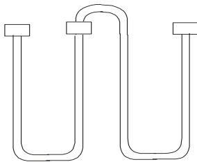
Насадочные представляют собой трубку с внутренним диаметром 4 – 8мм и длиной 0,5 – 10м. Трубка изготовлена из нержавеющей стали и содержит сорбент. Колонки помещаются в термостат, где температура поддерживается с точностью 0,5 – 0,1°C.
