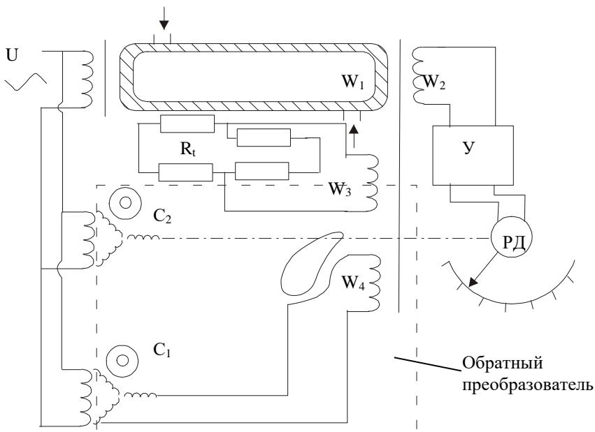
Все обмотки выполнены на одном железе, но W<sub>2</sub> и W<sub>3</sub> включены противофазно, по отношению к W<sub>1</sub>.
