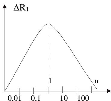
Левый склон графика охватывает высокие концентрации. Индуктивные датчики используют для измерения высококонцентрированных растворов электролитов.
