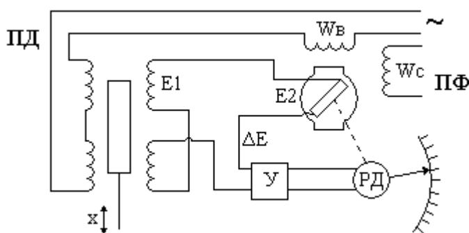
При перемещении плунжера возникает сигнал  $E_1$  и если он не равен  $E_2$ , на вход усилителя поступает сигнал  $\Delta E = E_1 - E_2$  и РД перемещает рамку до того момента, пока  $\Delta E$  не станет = 0.
