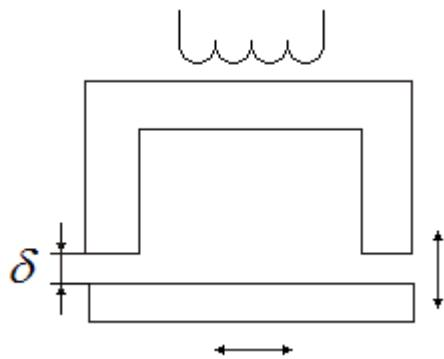
Предназначены для преобразования линейных и угловых перемещений в индуктивное сопротивление.
