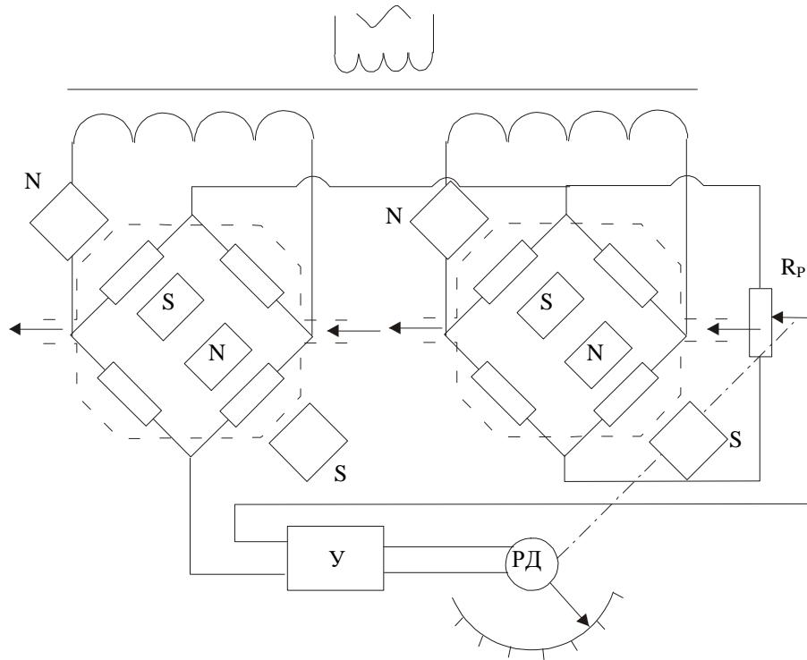
3. Ячейки, в которых направления тепловой и магнитной конвекции противоположны. Используются для измерения высоких концентраций кислорода (более 70%). Используются анализаторы, аналогичные предыдущему типу.
