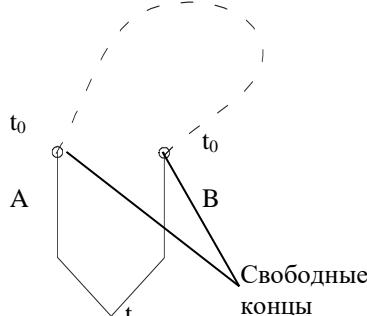
Для измерения этой ЭДС термопару необходимо разорвать. Свободные концы термопары соединены проводником.
