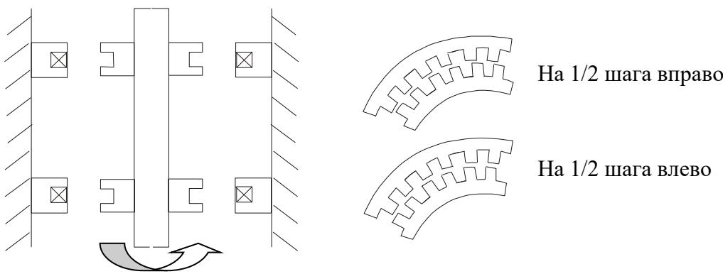
Магнитная цепь состоит из двух концентрических зубчатых сердечников, сдвинутых между собой на  $1/2$  шага зубьев. При повороте ротора изменяется взаимное расположение зубьев, а следовательно и полное сопротивление катушек индуктивности. Это сопротивление изменяется периодически, с периодом  $T = \frac{2\pi}{n}$ , где  $n$  - число зубьев.
