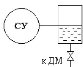
При измерении расхода пара соединительную линию и ДМ заполнена конденсатом (водой), а в непосредственной близости от сужающего устройства устанавливают конденсационные сосуды. Уровень держится постоянным.
