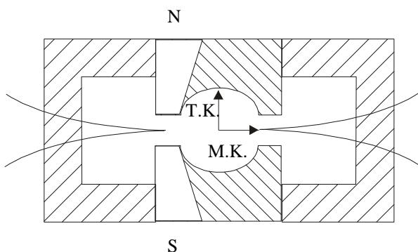
2. Такие ячейки, в которых направления магнитной и тепловой конвекции перпендикулярны. Применяются для измерения средних концентраций кислорода (20 – 70%). Недостаток – чувствительны к положению в пространстве. Для устранения этой погрешности используют сдвоенные ячейки, в которых магнитные конвекции противоположны по направлениям. Все чувствительные элементы являются плечами моста.
