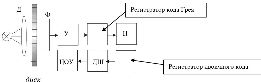
Д – диафрагма; Ф – фотоприемник; П – преобразователь; ДШ – дешифратор; ЦОУ – цифровое отсчетное устройство. На вращающемся диске нанесен код Грэя.
