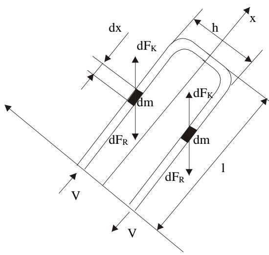
Трубка приводится в автоколебательный режим движения (незатухающие колебания).
