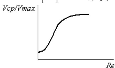
Трубку располагают по оси потока и определяют (измеряют)  $v_{max}$ . По  $v_{max}$  рассчитывают  $Re$  и по графику находят  $v_{cp}$ .
