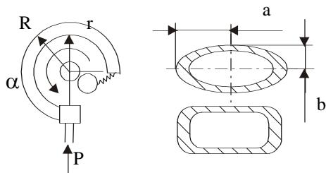
Давление подается внутрь трубы. Если внутрь трубы подают давление – она разгибается.
