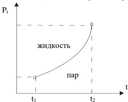
В них термобаллон лишь частично заполнен низкокипящей жидкостью, а сверху находится насыщенный пар этой жидкости. При изменении температуры изменяется давление насыщенного пара. Это изменение подается в манометр.
