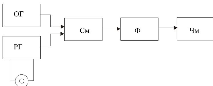
Частота рабочего генератора РГ зависит от C<sub>x</sub>.
