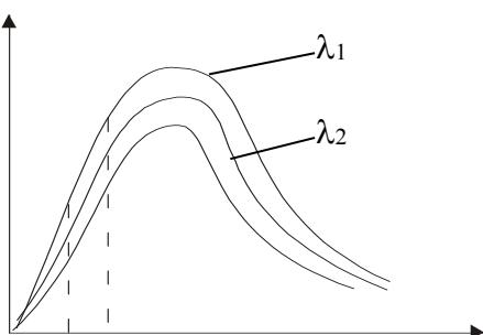
Выделяют 2 длины волн при помощи двух светофильтров, установленных на вращающемся диске. Основан на законе смещения Вина.
