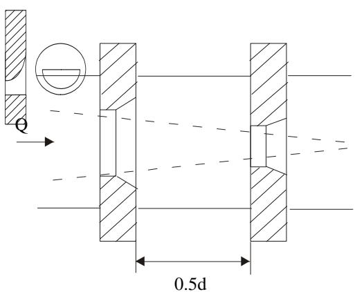
Сдвоенная диафрагма (образуется сопло с жидкостной стенкой)
