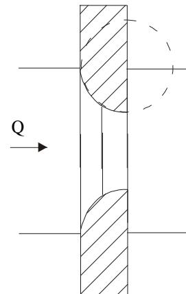
Диафрагма с профилем отверстия  $1/4$  круга.
