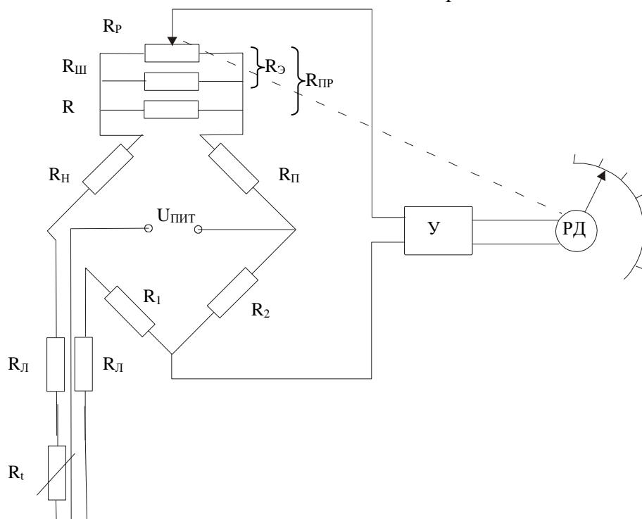
трехпроводную схему подключения термометра.
