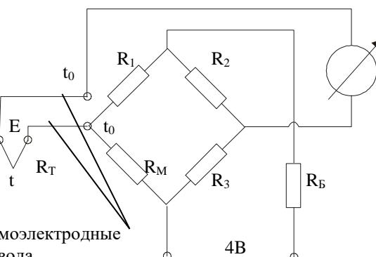
С помощью балластного сопротивления ( $R_B$ ) меняют напряжение питания моста.
