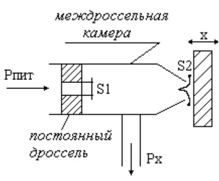
Воздух переходит через отверстие между соплом и заслонкой при подаче в сопло  $Рпит$ . Сопло и заслонка образуют переменный дроссель.  $Рпит$  – давление питания (140 кПа от редуктора). Давление междроссельной камере определяется расстоянием между соплом и заслонкой. Постоянный дроссель создаёт делитель давления, иначе в междроссельной камере было бы  $Рпит$ .
