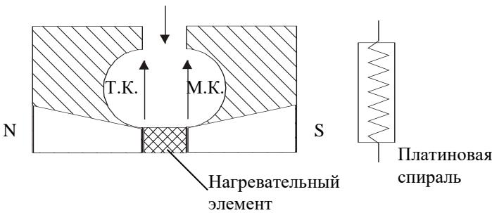
присутствуют два вида конвекции, а в другой – только тепловая. Эти ячейки включают в схемы компараторов.
