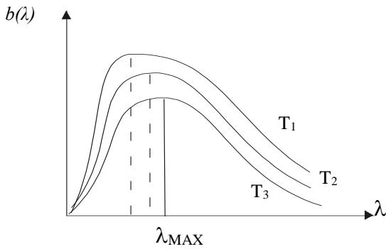
Полная энергия яркости определяется площадью под кривой спектральной плотности яркости.
