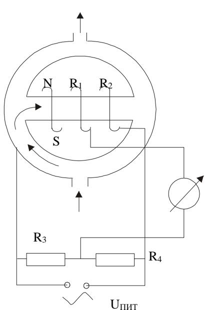
попадают в зону высокой температуры, созданную спиралью и теряют свои магнитные свойства, а следующие за ними холодные молекулы начинают проталкивать уже нагретые вдоль горизонтального канала. При этом тепло из секции  $R_1$  передается к секции  $R_2$ . Недостаток – низкая чувствительность спирали. Выходной сигнал зависит от расположения датчика в пространстве.
