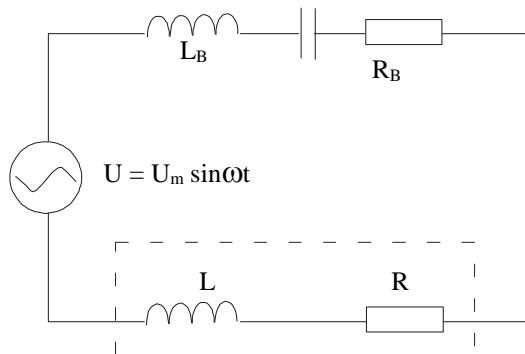
Пунктиром отмечены элементы, характеризующие параметры жидкости.
