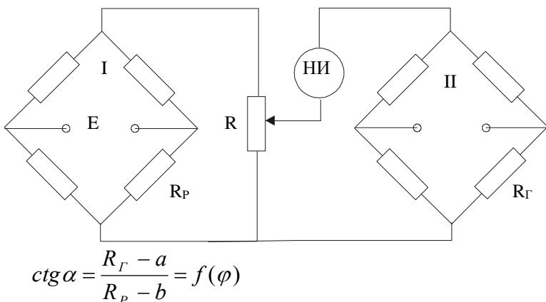
Выходной сигнал первого моста  $U_I = EK_1(R_p - b)$
