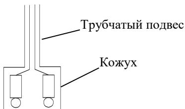
Погружные для защиты электродов закрывают кожухом. Высота трубчатого подвеса определяется высотой аппарата.
