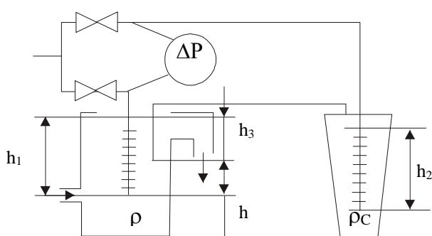
Принцип действия основан на измерении давления столба жидкости постоянной высоты.
