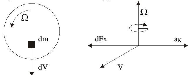
Ускорение Кориолиса направлено перпендикулярно плоскости, проходящей через вектора  $\Omega$  и  $V$ , в ту сторону, откуда кратчайшее совмещение  $\Omega$  и  $V$  происходит против часовой стрелки.
