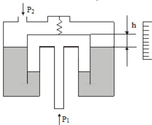
Выходной сигнал – перемещение колокола. Могут быть уравновешивающими гидростатическими (поплавок) и механическими (пружина).
