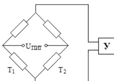
T<sub>1</sub> наклеиваются на деформируемую деталь, а T<sub>2</sub> – на недеформируемую, но имеющую ту же температуру. Выходной сигнал моста подается на усилитель, т.к. U<sub>пит</sub> не может быть большим.
