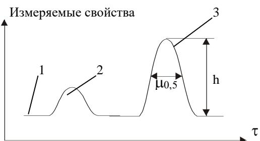
1 – нулевая линия, соответствующая сигналу детектора, через который проходит чистый газ-носитель
