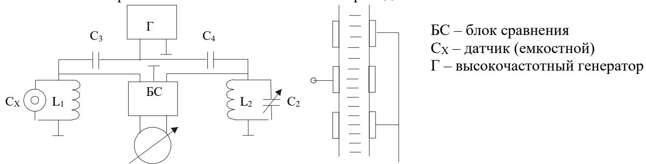
В этой схеме использован дифференциальный способ измерения, т.е. есть рабочий и сравнительный контура.
