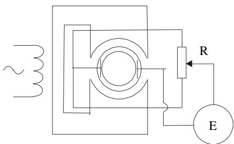
При использовании переменного магнитного поля может возникнуть так называемая трансформаторная ЭДС, создает погрешность. Даже при неподвижной жидкости может быть сигнал. При неподвижной жидкости устанавливают ноль при помощи  $R$ -делителя.
