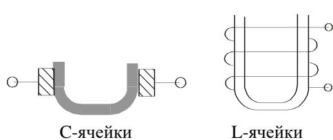
Диапазон частот напряжения питания от одного до нескольких сотен МГц. В зависимости от типа датчика различают емкостную и индуктивную кондуктометрию.
