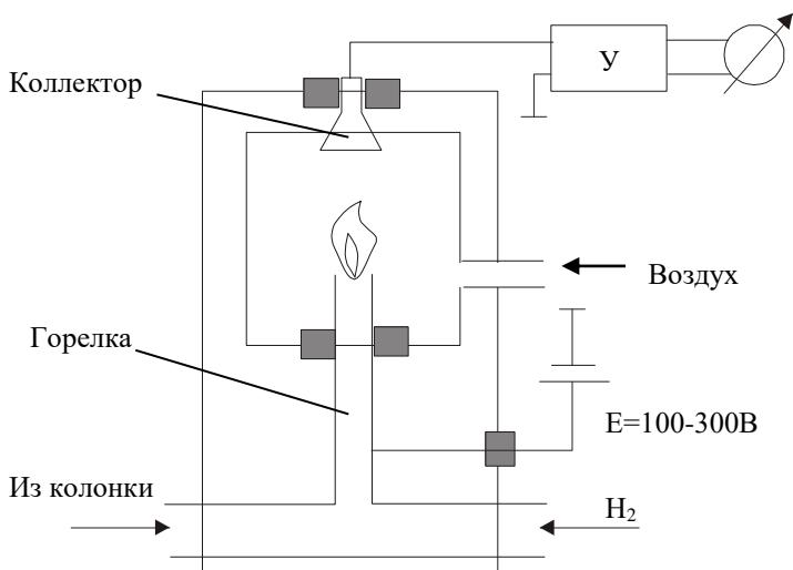
Принцип действия основан на ионизации анализируемого вещества в водородном пламени. Ионизирующийся участок находится между горелкой и коллектором. Чувствительность  $10^5$  единиц по Нортеру – самая высокая.
