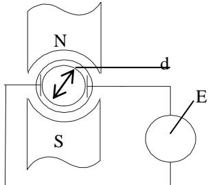
Между полюсами расположен участок трубы из непроводящего материала. Во внутреннюю стенку трубы вплавляются 2 электрода. Силовые линии магнитного поля пересекают движущийся поток жидкости. Поток жидкости ведет себя как рамка в магнитном поле. В нем наводится ЭДС при пересечении магнитными линиями.
