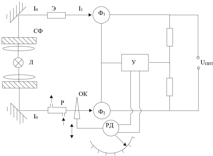
Проще реализуется первая схема, но она менее точна, т.к. на результат измерения будет влиять характер статической характеристики фотоприемника в рабочем канале.
