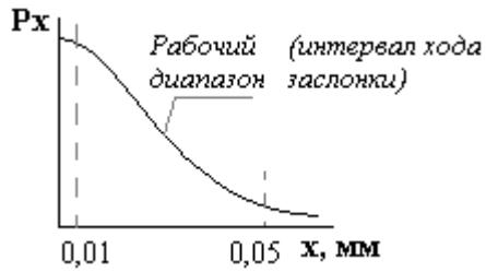
Преобразователь работает по принципу следящего статического уравновешивания. Нужно создать местное сопротивление, чтобы получилось  $P_x$  (делитель давления)
