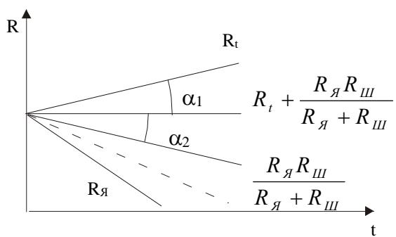
$\chi = \chi_0(1 + \alpha t)$  - удельная электрическая проводимость
