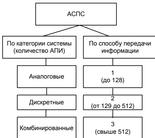
Рис. 2.8. Классификация адресных систем пожарной сигнализации
