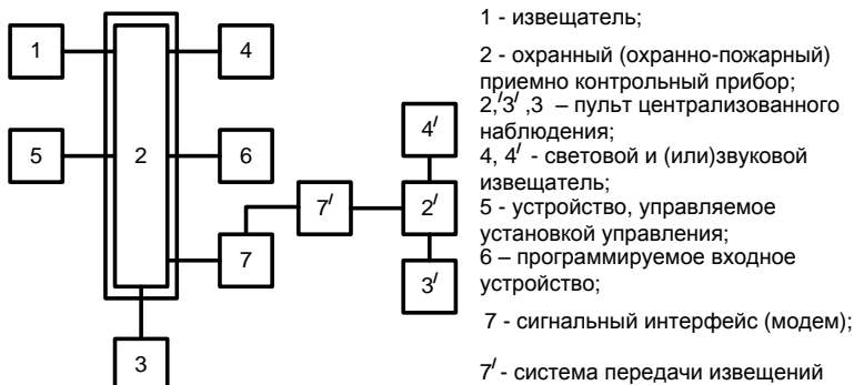
Рис. 2.7. Система пожарной сигнализации.
