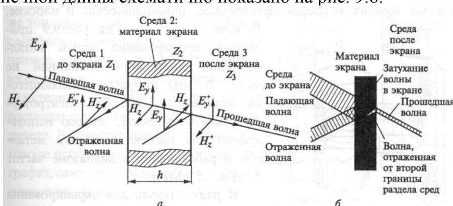
Рис. 9.8. Экранирование электромагнитных волн плоским экраном: а — прохождение волны сквозь экран; б — примерный амплитудный баланс
