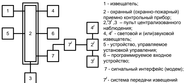
Рис. 2.7. Система пожарной сигнализации.
