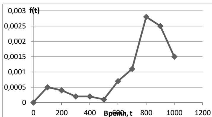
Рисунок 2.2 – График зависимости плотности распределения отказов во времени
