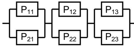
Рисунок 6.2 – Схема системы с поэлементным резервированием:
