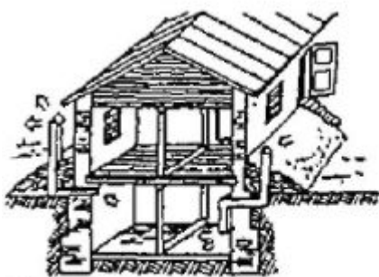
Противорадиационное укрытие в подвале дома
