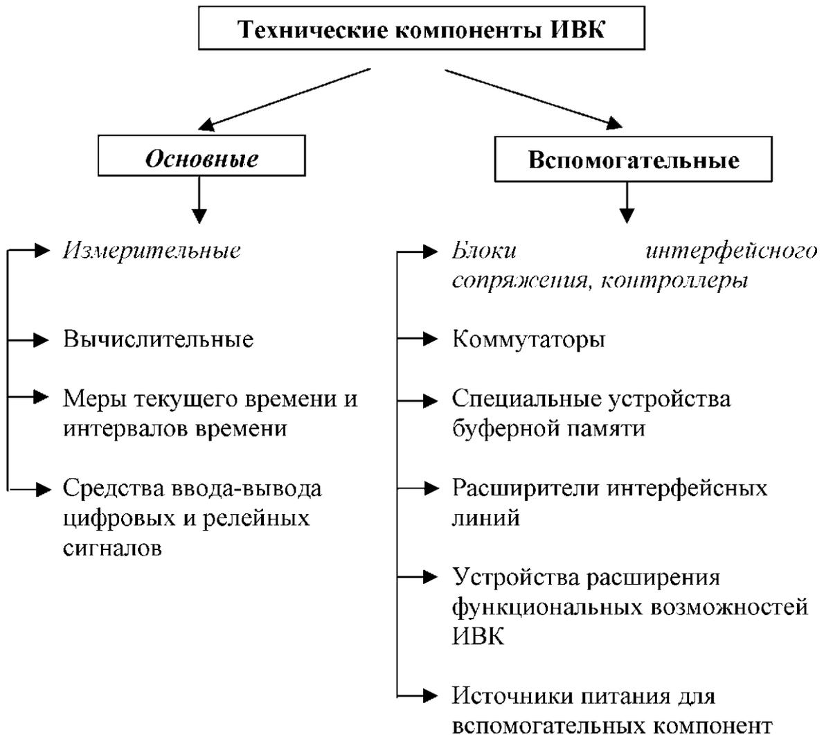
Рис. 4.1. Состав технических компонентов ИВК
