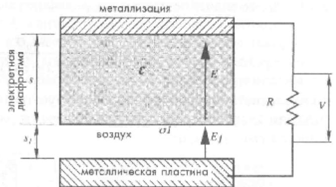
Рис. 5. Структура электретного микрофона.
