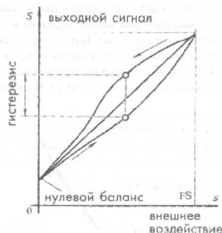
Рис. 3. Передаточная функция с гистерезисом
