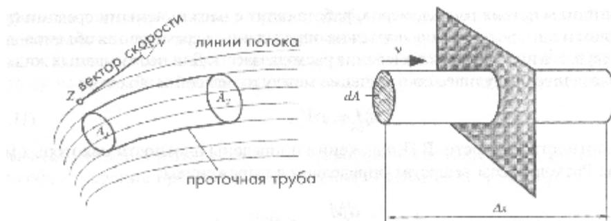
Рис. 1. Проточная трубка, поток вещества через поперечное сечение.
