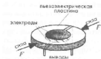
Рис. 4. Пьезоэлектрический дисковый резонатор, применяемый в диаметральной датчике силы
