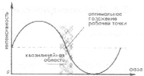
Рис. 3. Зависимость интенсивности излучения от фазы отраженного сигнала.
