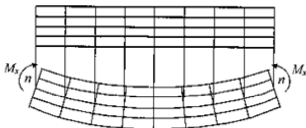
Рис. 2. Модель чистого изгиба.
