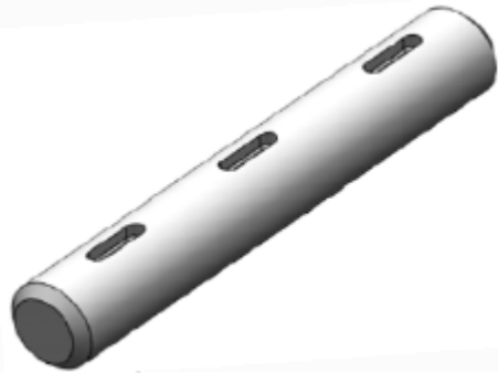
Рис. 4. Прямой вал постоянного диаметра.
