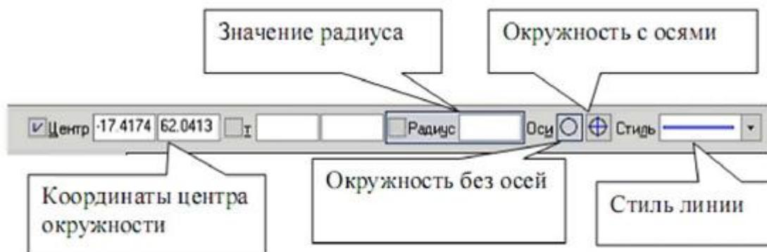
Рис.29. Параметры построения окружности.
