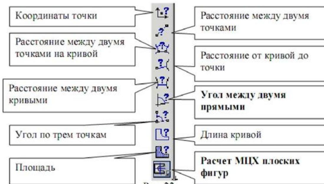
Рис.25. Команды: *Угол между двумя прямыми, Расчет МЦХ плоских фигур.*
