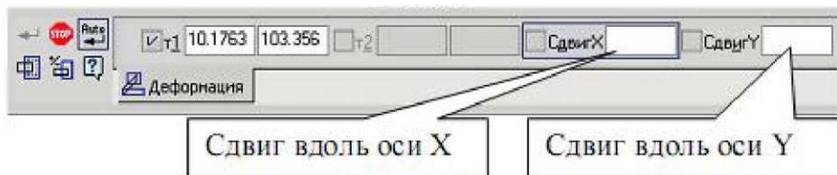
Рис. 88. Строка параметров команды *Деформация сдвигом*.
