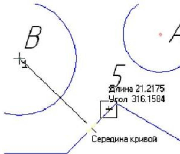
Рис.43. Построение отрезка к середине.
