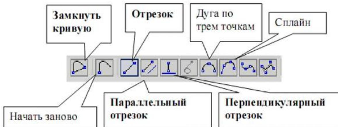
Рис.23. Команды: *Параллельный отрезок, Перпендикулярный отрезок, Замкнуть кривую*.
