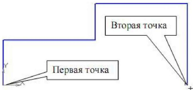
Рис. 67. Построение осевой линии.
