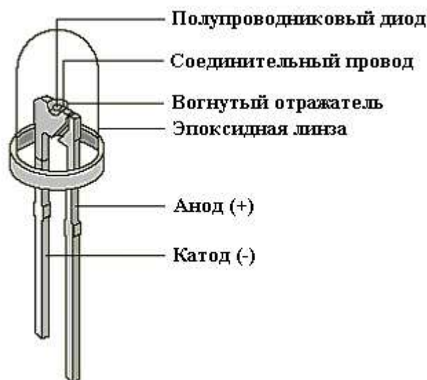
Рис. 5.1. Конструкция светодиода
