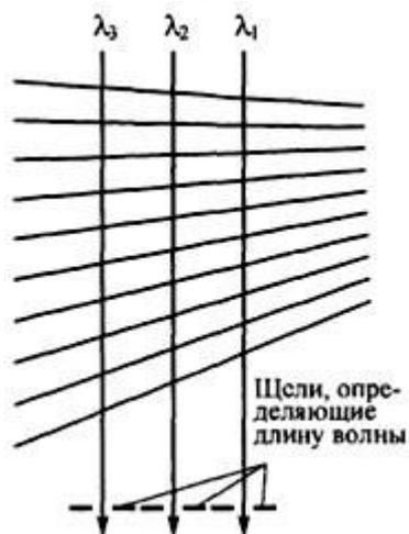
Рис. 3. Конический интерференционный фильтр
