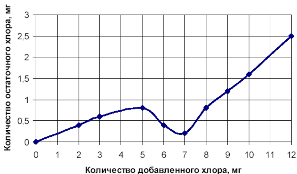
Рис. 19. Кривая йодометрического титрования активного хлора
