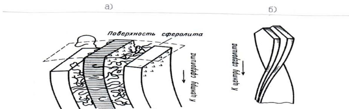
**Рис. 7.8.** Схематическое изображение расположения ламелей вдоль радиуса сферолита:
