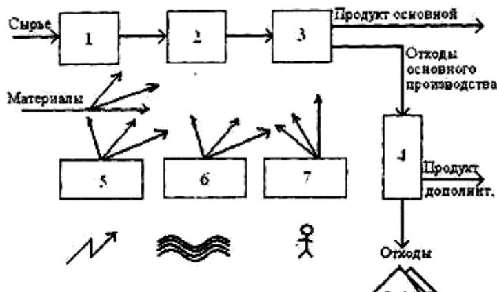
а) выделение продукта; б) санитарная очистка и утилизация отходов; в) подготовка сырья; г) водоподготовка; д) химическая переработка сырья; е) энергетическая система; ж) система управления.
