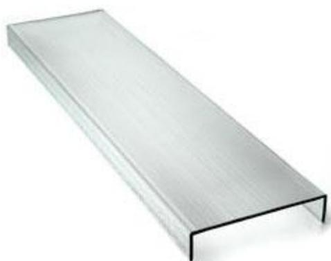
**Профильное строительное стекло.** Профильное строительное стекло представляет собой элементы швеллерного и коробчатого сечения, формируемые на горизонтальных прокатных установках, в виде бесконечной ленты, разрезаемой затем на отрезки длиной до 6000 мм. Профильное стекло может быть бесцветным или окрашенным.
