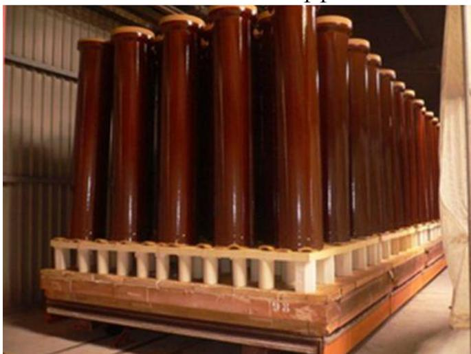
Канализационные трубы должны (рис. 27) быть плотными, водонепроницаемыми, кислотостойкими, выдерживать внутреннее гидравлическое давление не менее 0,2 МПа в течение 5 мин, внешнее усилие в 2—3 т на погонный метр трубы.
