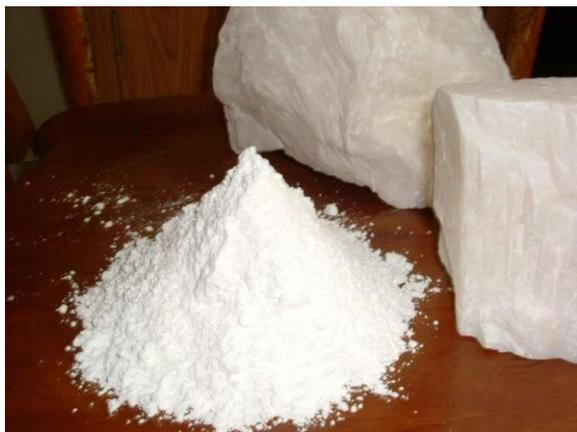
компонентами керамической массы. Однако большое содержание железистых примесей в глинах недопустимо для огнеупоров и беложгущихся керамических изделий (фарфор, фаянс, фасадная керамика светлых тонов).
