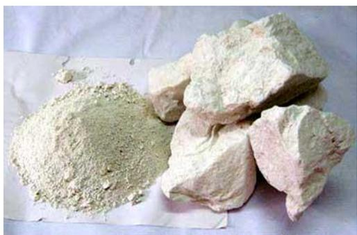
Химическая формула глины -  $n\text{Al}_2\text{O}_3 \cdot m\text{SiO}_2 \cdot p\text{H}_2\text{O}$ .
