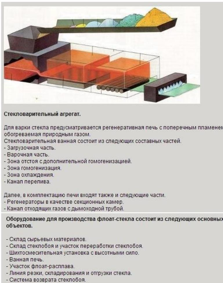
**Рис. 34.** Технологическая цепочка для получения стекла флоат-способом
