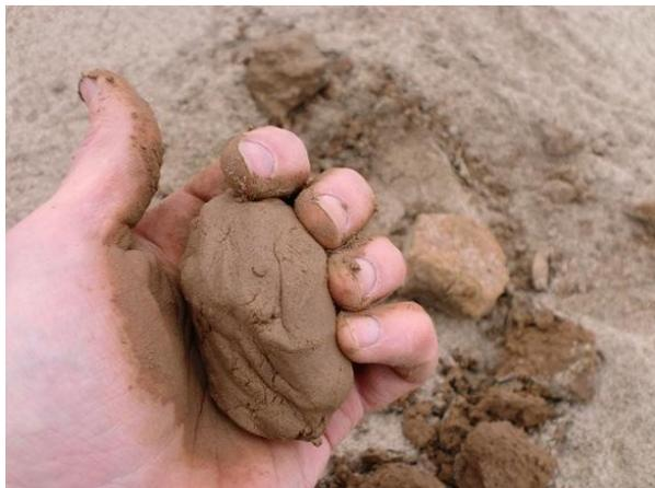
**Глины.** Глины являются главным, иногда даже единственным компонентом керамических масс в производстве, например, строительного кирпича, фасадной керамики, различных плиток, канализационных труб, шамотных огнеупоров; в то же время глины используют как добавку в производстве огнеупоров и других видов керамики.
