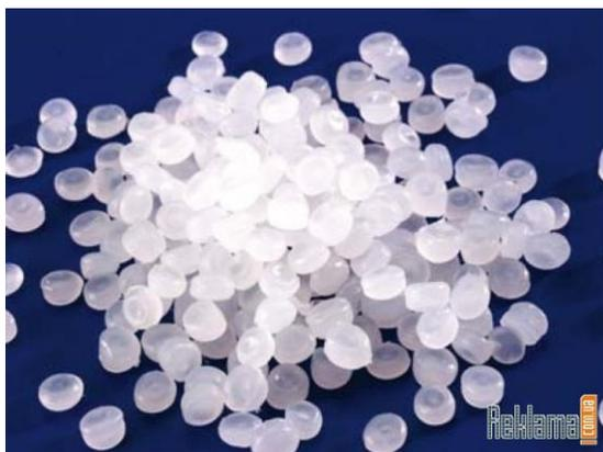
действию концентрированных кислот и щелочей, однако разрушается при воздействии сильных окислителей. Обладает низкой газо- и паропроницаемостью. Звенья ПЭ неполярны, поэтому он обладает высокими диэлектрическими свойствами и является высокочастотным диэлектриком. Практически безвреден.
