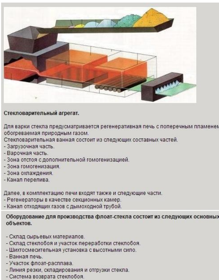
Рис. 34. Технологическая цепочка для получения стекла флоат-способом
