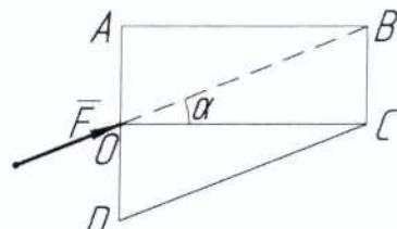
Дано: модуль силы  $\bar{F}$ , угол  $\alpha$ , геометрические размеры прямоугольника ABCO и треугольника CDO следует считать известными.
