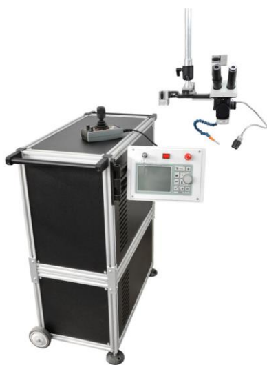
Рис. 43. Внешний вид станка для лазерной сварки модели МУЛ-3D [26]
