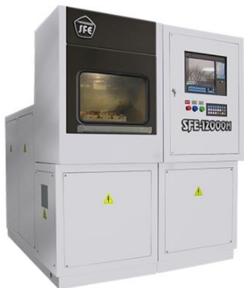
Рис. 11. Внешний вид электрохимического копировально-прошивочного станка SFE-12000M [12]
