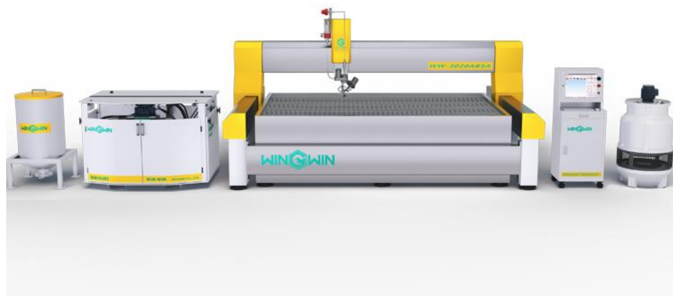
Рис. 61. Внешний вид 5-ти осевого станка модели AC3015 для гидроабразивной обработки деталей [37]
