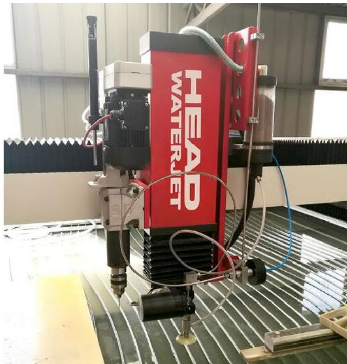
Рис. 62. Внешний вид сверлильной головки HeadWaterJet [38]
