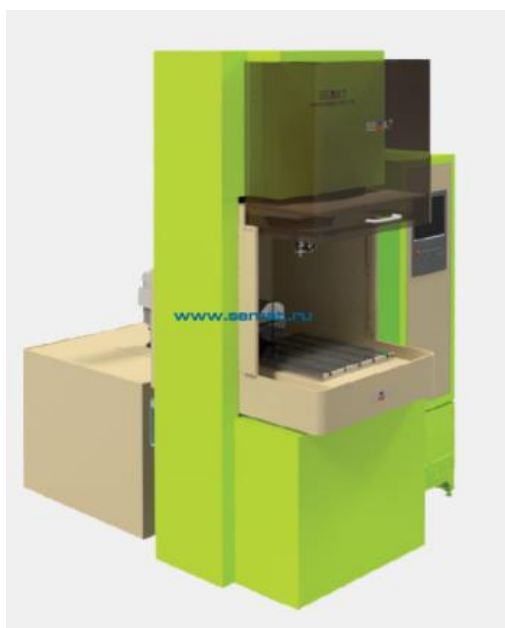
Рис. 15. Внешний вид электрохимического станка SEMAT серии Sk-ECM [13]
