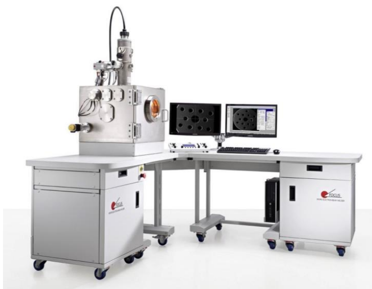
Рис. 45. Внешний вид установки для проведения электронно-лучевой сварки модели Focus МЕВW-60 [28]
