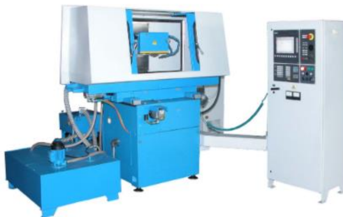
Рис. 33. Внешний вид станка для электрохимического шлифования модели ОШ-625ЭФ3 [21]
