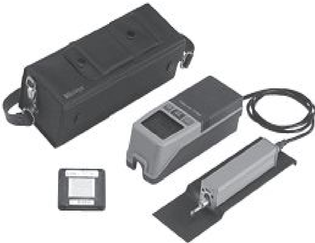
Рис. 5. Общий вид профилометра Mitutoyo Corp. SurfTest SJ-201
