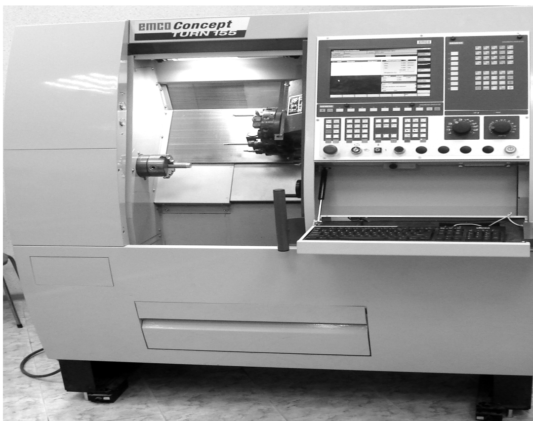
Рис. 1. Общий вид токарно-фрезерного станка EMCO CONCEPT TURN 155
