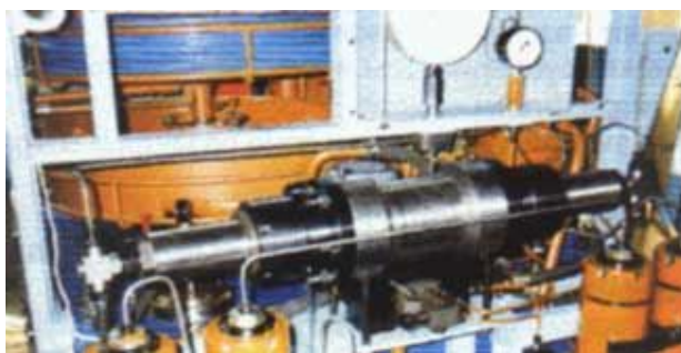
Рис. 10. Общий вид установки и двухстороннего мультипликатора
