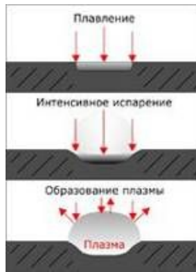
Рис. 5. Схема лазерной гравировки металлов
