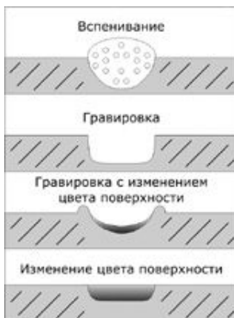
Рис. 4 . Схема лазерной маркировки пластмасс
