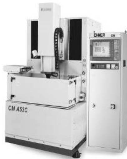
Рис. 14. Общий вид электроэрозионного прошивного станка CHMER CM A53C с ЧПУ
