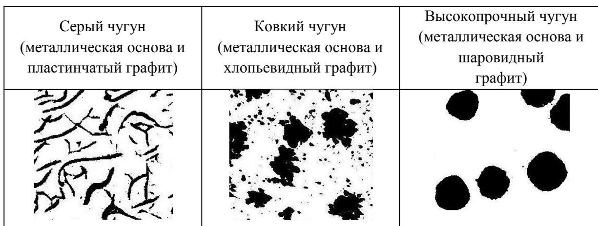
*Рис.27. Микроструктуры чугунов*
