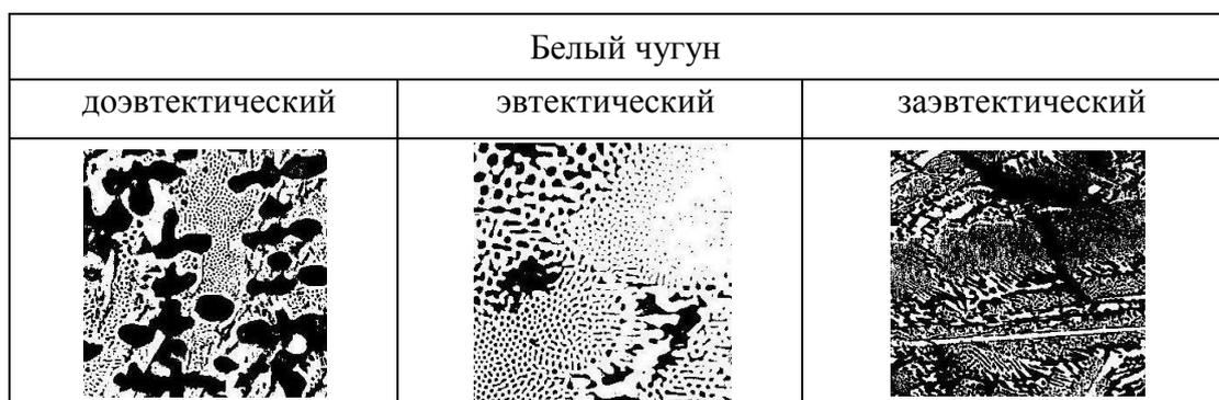
Рис.26. Микроструктуры белых чугунов
