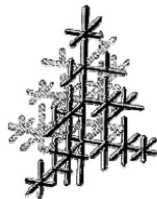
*Рис.12. Схема древовидного кристалла (Д.К. Чернов)*
