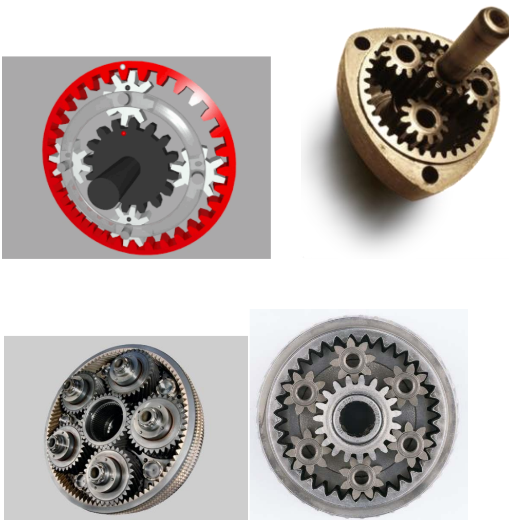
Рис. 2. Примеры планетарных механизмов
