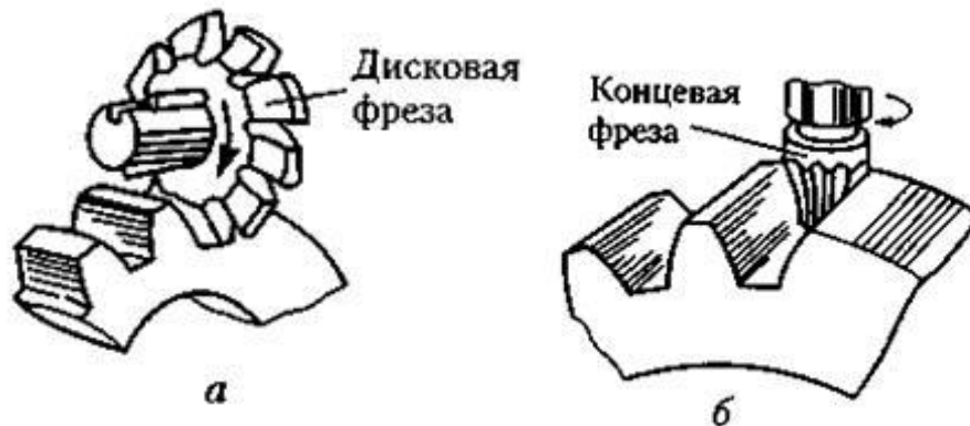
Рис. 38. Фрезерование зубьев цилиндрического колеса
