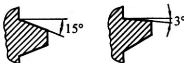
Рисунок – Виды сечений витка резьбы
