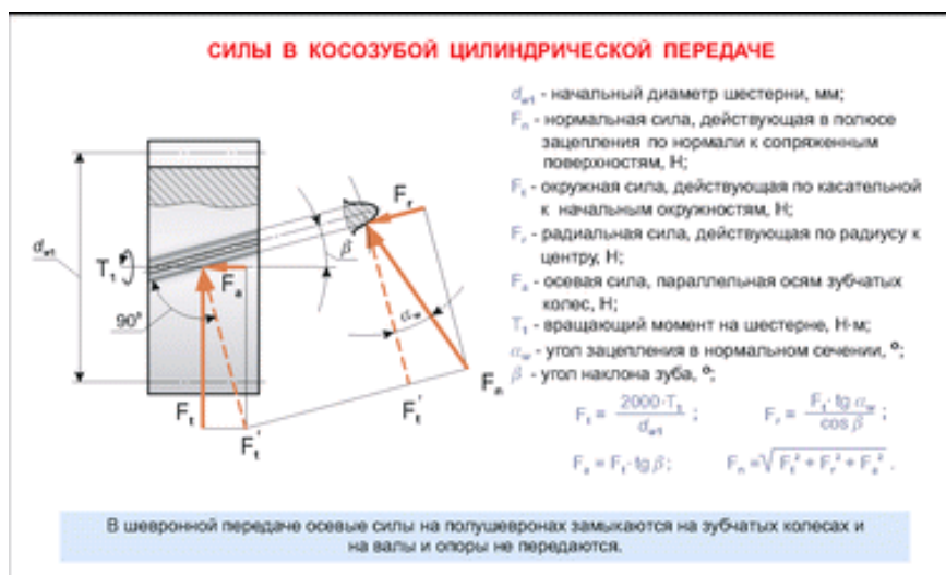
Рисунок – Силы, действующие в зацеплении косозубой цилиндрической передачи
