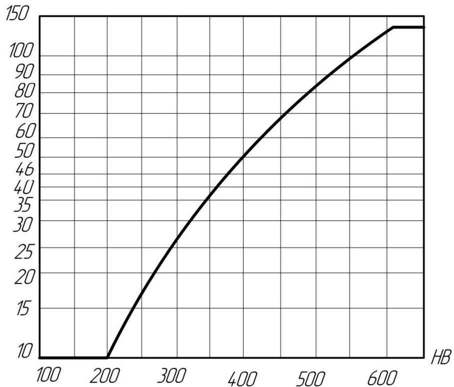
Рис. 2.2. Базовое число циклов перемены напряжений  $N_{H0}$
