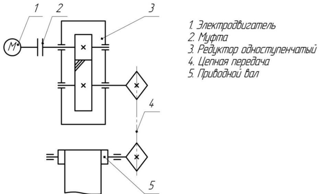
2) КПД редуктора (одноступенчатый цилиндрический).
