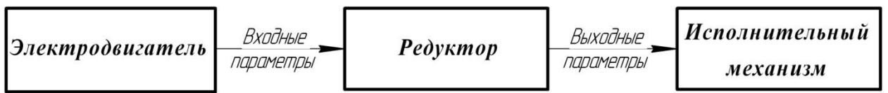
Основными входными и выходными параметрами механического привода являются: мощность  $N$ , кВт; частота вращения  $n$ , мин $^{-1}$ ; крутящий момент  $T$ , Нм. Потери мощности от электродвигателя к исполнительному механизму характеризует коэффициент полезного действия (КПД) привода, который определяется как произведение КПД составляющих элементов и передач:  $\eta_{общ} = \eta_1 \cdot \eta_2 \cdot \eta_3 \cdot \dots$ .
