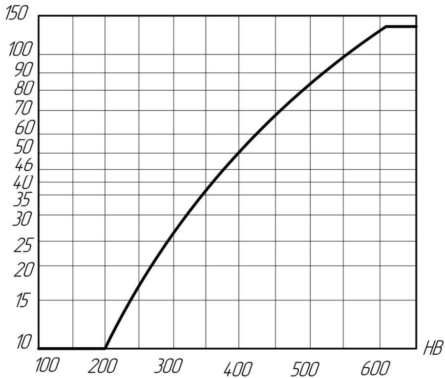
Рис. 2.2. Базовое число циклов перемены напряжений  $N_{НО}$
