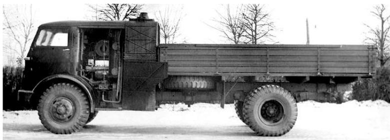
Рис. 10. Паровой автомобиль НАМИ-012 1949 года
