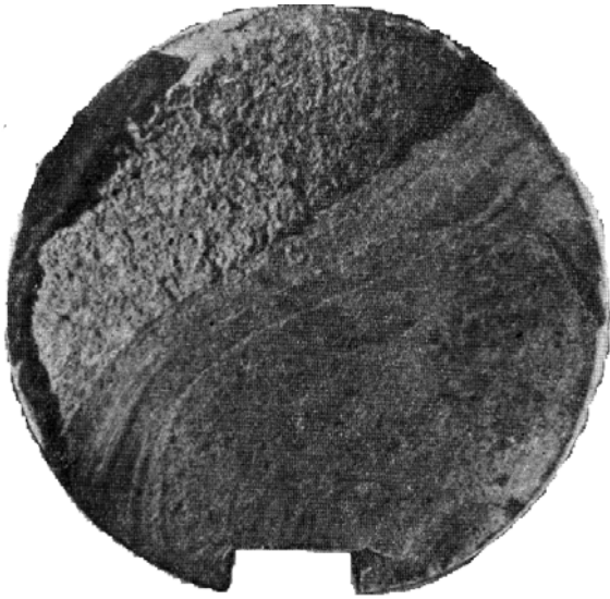
Рис. 15. Характерный внешний вид усталостного излома металла
