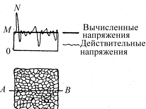
Рис. 17. Вычисленные и действительные напряжения в металле по линии A-B
