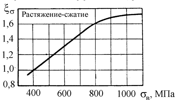
Рис. П9.2. Определение действительного коэффициента концентрации напряжений с учетом предела прочности
