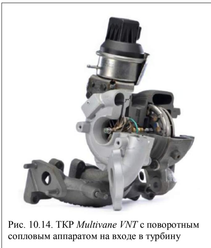
Рис. 10.14. ТКР *Multivane VNT* с поворотным сопловым аппаратом на входе в турбину
