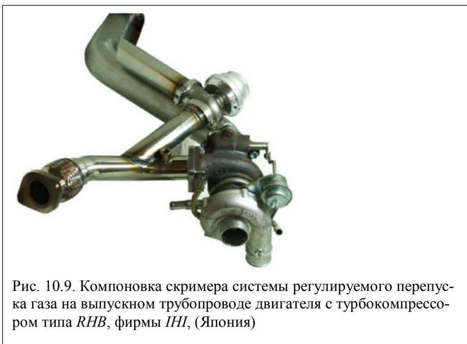
Рис. 10.9. Компоновка скримера системы регулируемого перепуска газа на выпускном трубопроводе двигателя с турбокомпрессором типа *RHB*, фирмы *ИИ*, (Япония)
