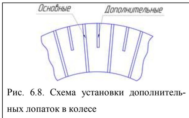
Рис. 6.8. Схема установки дополнительных лопаток в колесе
