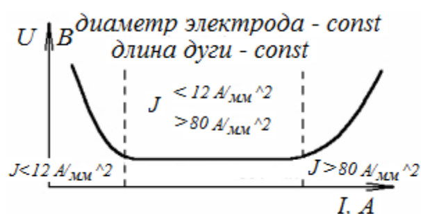
Рис. 2.7. Статическая вольтамперная характеристика электрической дуги.
