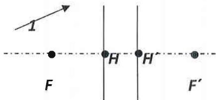
22. Графическим построением найти изображение предмета  $B_1B_2$ , если он образует с оптической осью отрицательной оптической системы  $HH'$  угол  $\psi$  и  $-f = f'$ .
