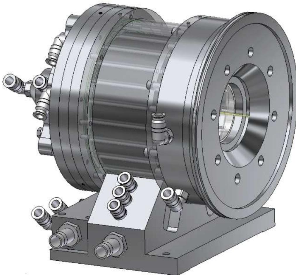
Рис. 14. Мощный усилительный модуль с дисковым активным элементом.
