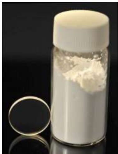
Рис.19. Керамический образец оптического качества (слева), нанопорошок, полученный лазерным испарением (справа)
