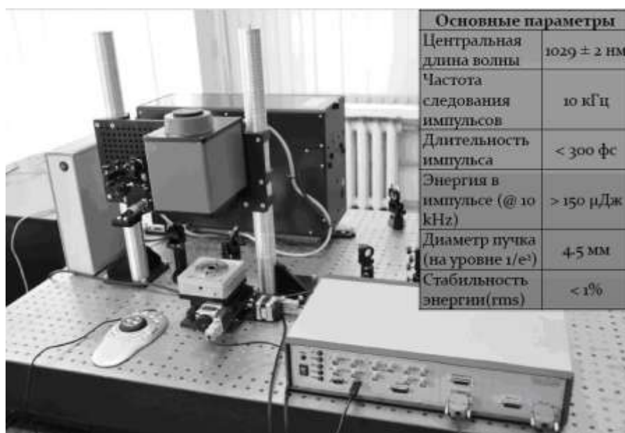
Рисунок 10. Фемтосекундная лазерная система ТЕТА-10
