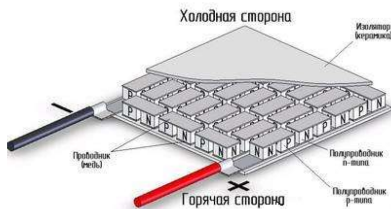
Рис.3. Схема термобатареи (модуля) Пельтье.
