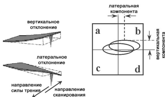
Рис. 2.3. Смещение лазерного пятна при отклонении кантилевера
