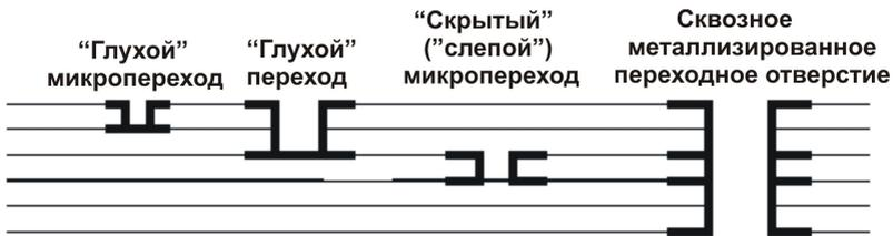
Рис. 3.1. Типы переходных отверстий
