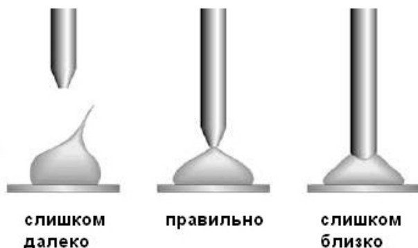
Рис. 1.9. Расположение наконечника дозатора
