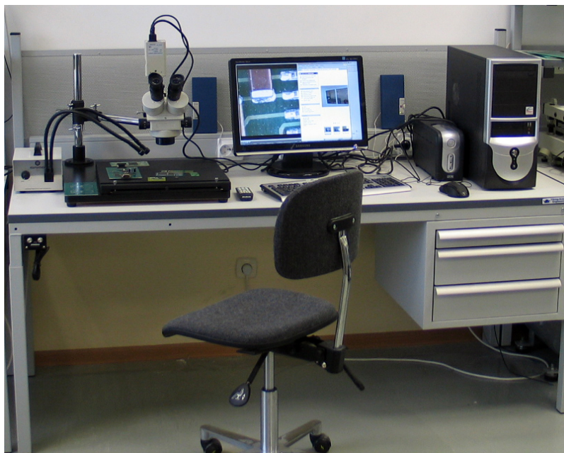
Рис. 3.8. Рабочее место визуального контроля
