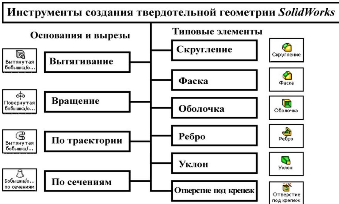
Рис. 3.1. Методы создания твердотельной модели в *SolidWorks*
