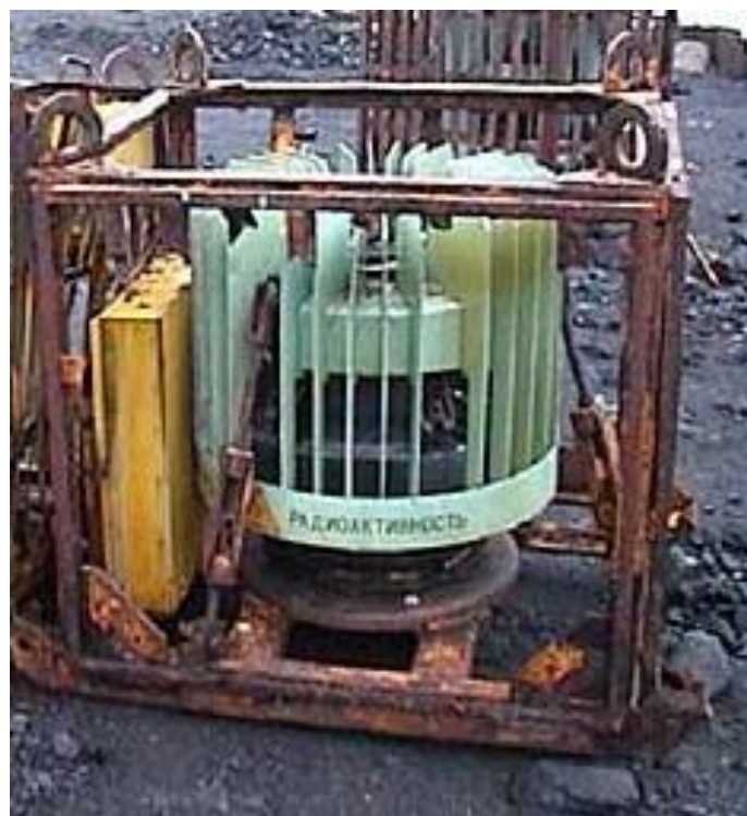
Рис. 23. Разбитый штормом радиоизотопный генератор БЕТА-М для морских маяков
