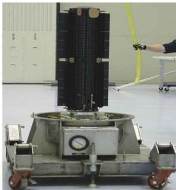
Рис. 19. Радиоизотопные генераторы космического зонда «Вояджер» и космического аппарата «New Horizons»
