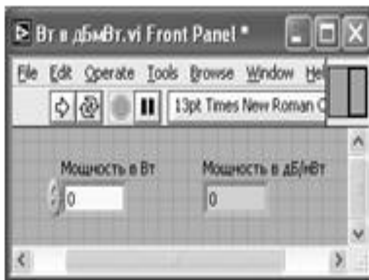
Рис. 15. Лицевая панель СубВИ «Вт в дБмВт»
