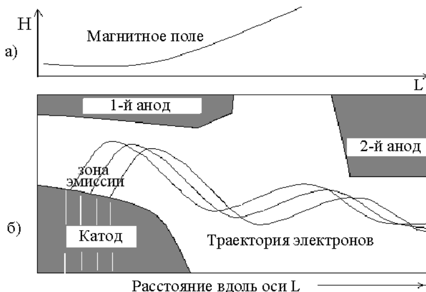
Рис. 2.19. Движение электронов около катода гиротрона
