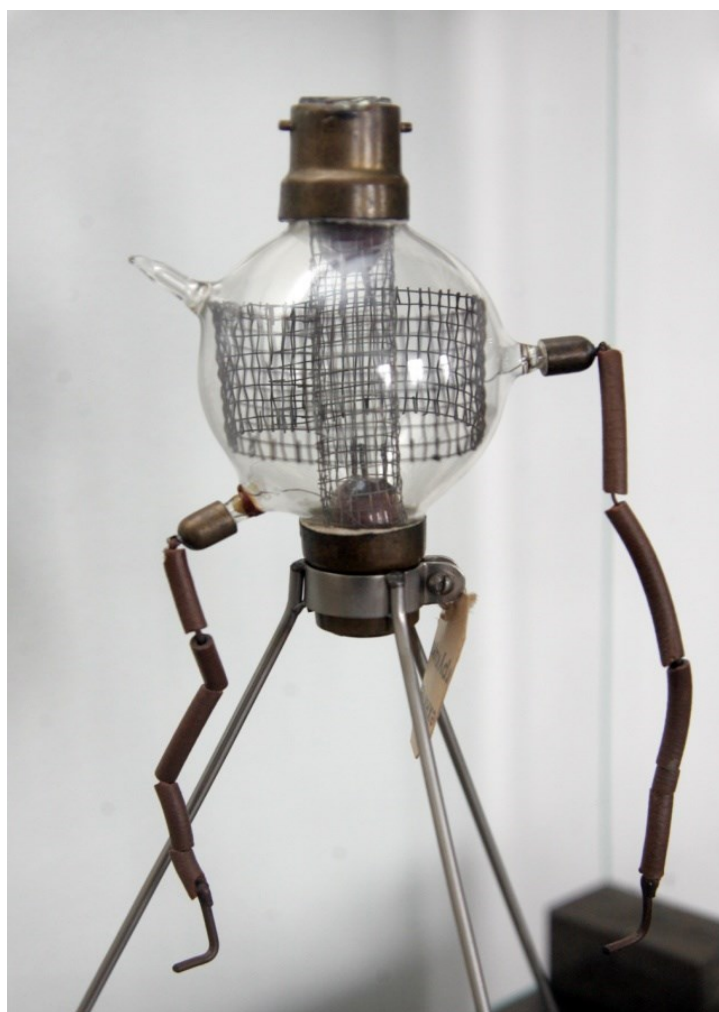
Рис. 1.6. Первая в мире радиолампа с водяным охлаждением
