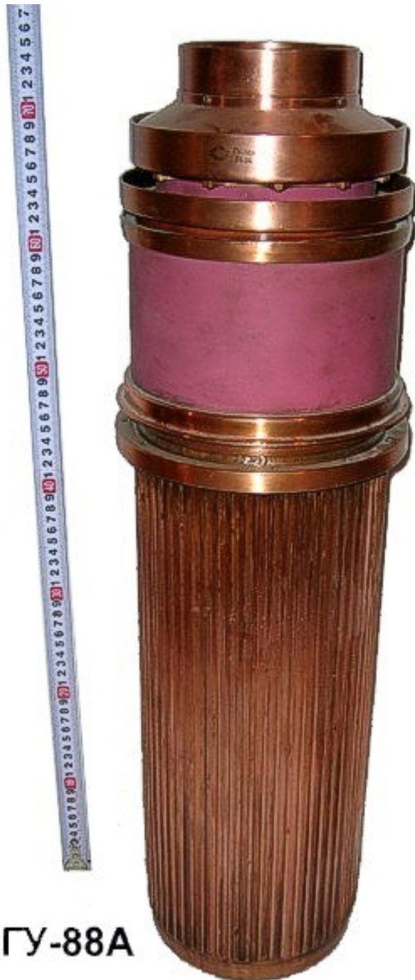
Рис. 1.7. Радиолампа мощностью 500 кВт
