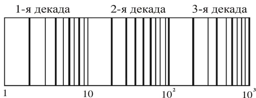
Рисунок 5.12- На оси абсцисс диаграммы построена логарифмическая шкала
