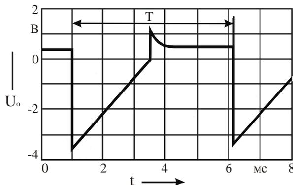
Рисунок. 5.11- Осциллограмма напряжений на базе транзистора в мультивибраторе
