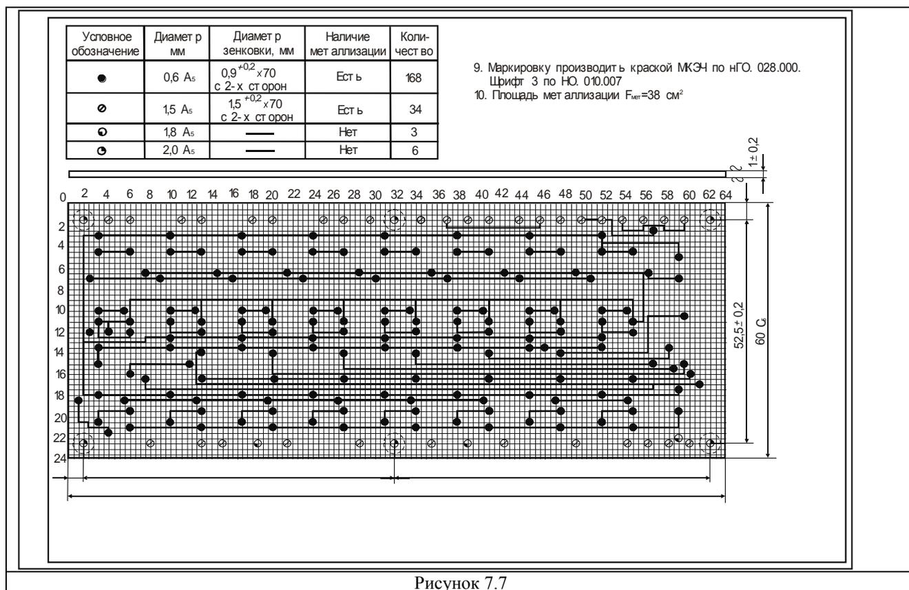
Рисунок 7.1- Оформление сборочных чертежей печатных плат
