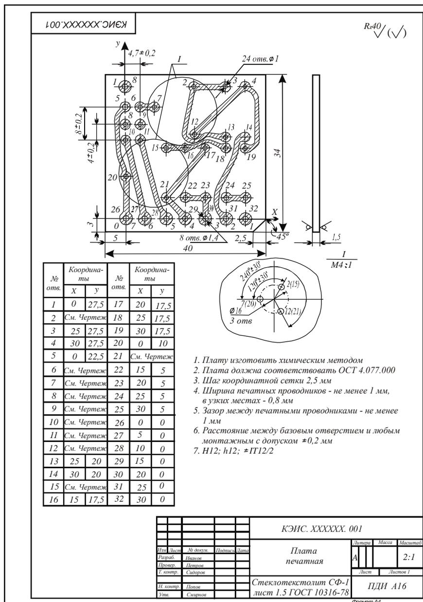
Рисунок 7.6 - Чертеж печатной платы с проводниками произвольной формы
