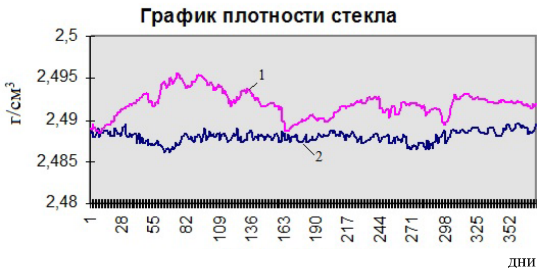
Рис. 3.2. Изменение плотности стекла (1 – фактическое и 2 – при управлении) в процессе варки
