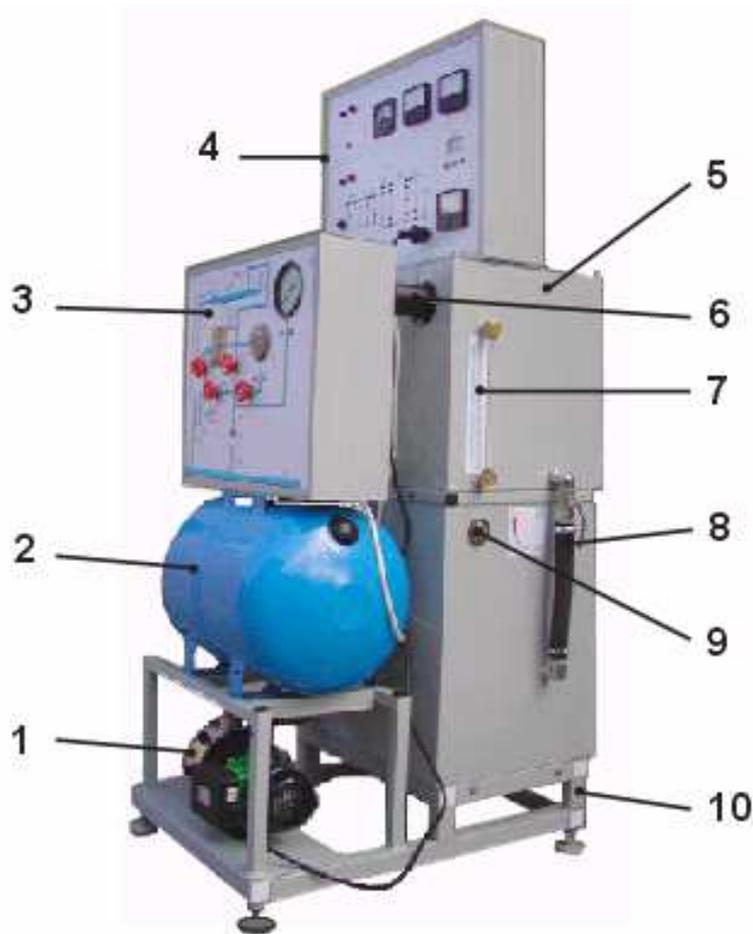
*Рис. 1.2. Общий вид стенда: 1 – насосная установка, в состав которой входят центробежный насос (Н) и однофазный приводной электродвигатель; 2 – пневматический бак (ПБ); 3 – модуль гидравлического управления (МГУ); 4 – модуль электрического управления; 5 – гидробак верхний (Б2); 6 – потенциометрический датчик уровня (ДУ); 7 – указатель уровня воды в верхнем гидробаке (УУ); 8 – гидробак нижний (Б1); 9 – указатель уровня воды в нижнем гидробаке (заменен на трубчатый указатель); 10 – рама стенда*
