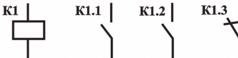
*Рис. 2.2. Условное графическое обозначение электромагнитного реле*
